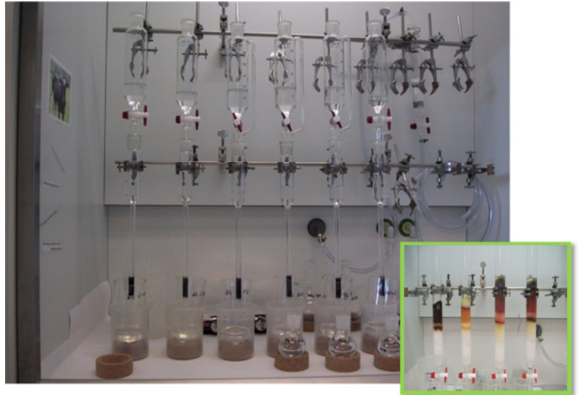
Die säulenchromatographischen Aufreinigungsschritte erfolgen manuell.
