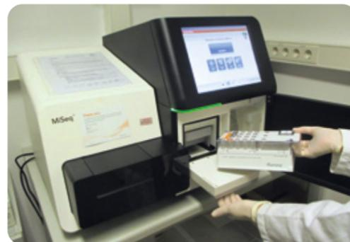
Zum Start der Sequenzierung: Beladen des MiSeq (Next-Generation-Sequenzierer) mit der Sequenzierkartusche.
