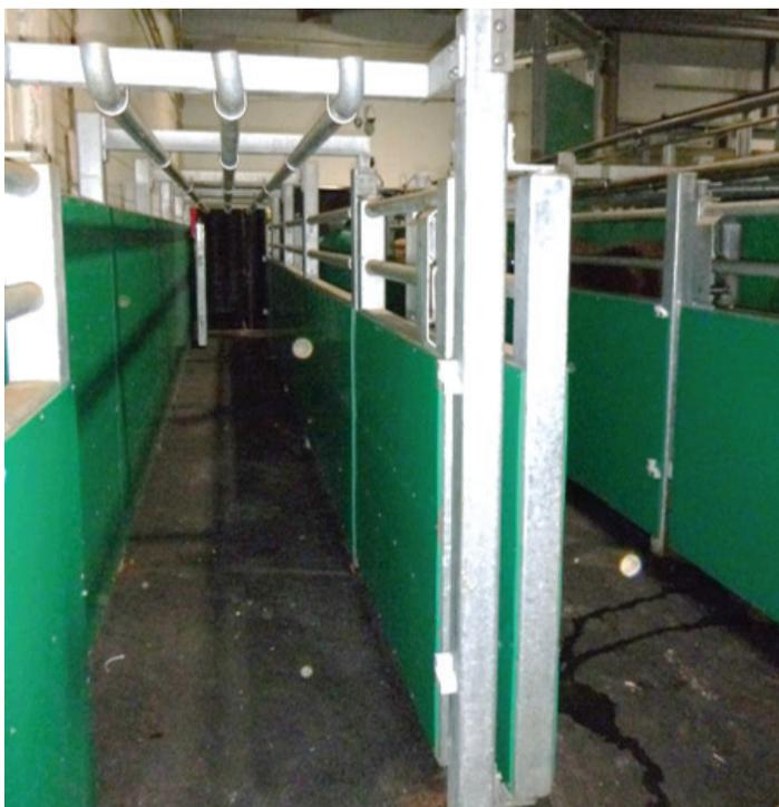
In der neuen Betäubungsfalle werden die Rinder kurz und sicher fixiert und mit einem pneumatischen Bolzenschussapparat betäubt.
