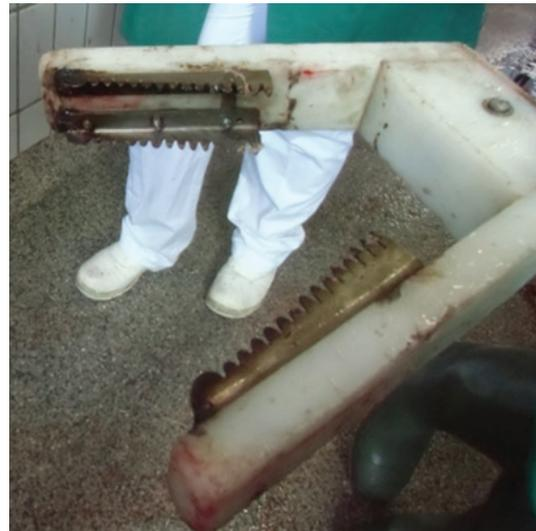
Elektroden abgenutzt, Verschmutzungen eingebrannt
