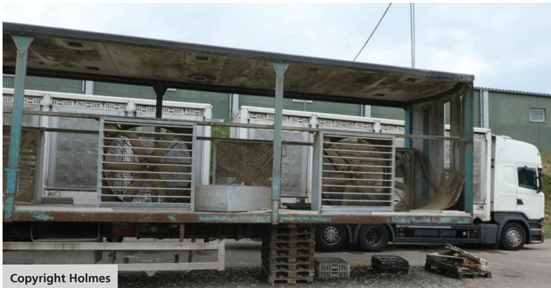
Abb. 3 Ventilatoren auf Schlachtbetrieb zur Kühlung von Tieren auf Transportfahrzeugen vor Abladen
