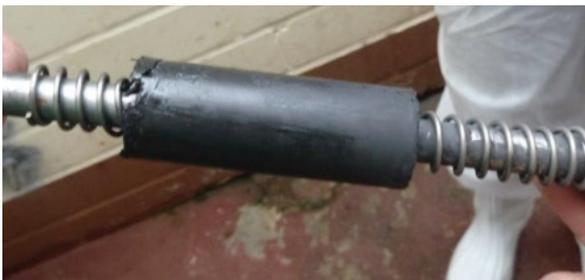
Bolzenschuss: Verschleiß am Gummipuffer
