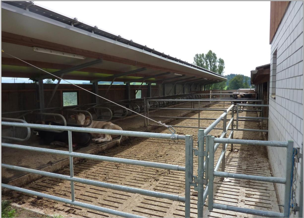
Abb. 7: Durch Anbau eines Auslaufes und einer Liegeboxenreihe an eine übliche Buchtenhaltung lässt sich der Tierkomfort durch zusätzliche Bewegungsfläche und Klimareize steigern (Foto: Tierschutzdienst).
