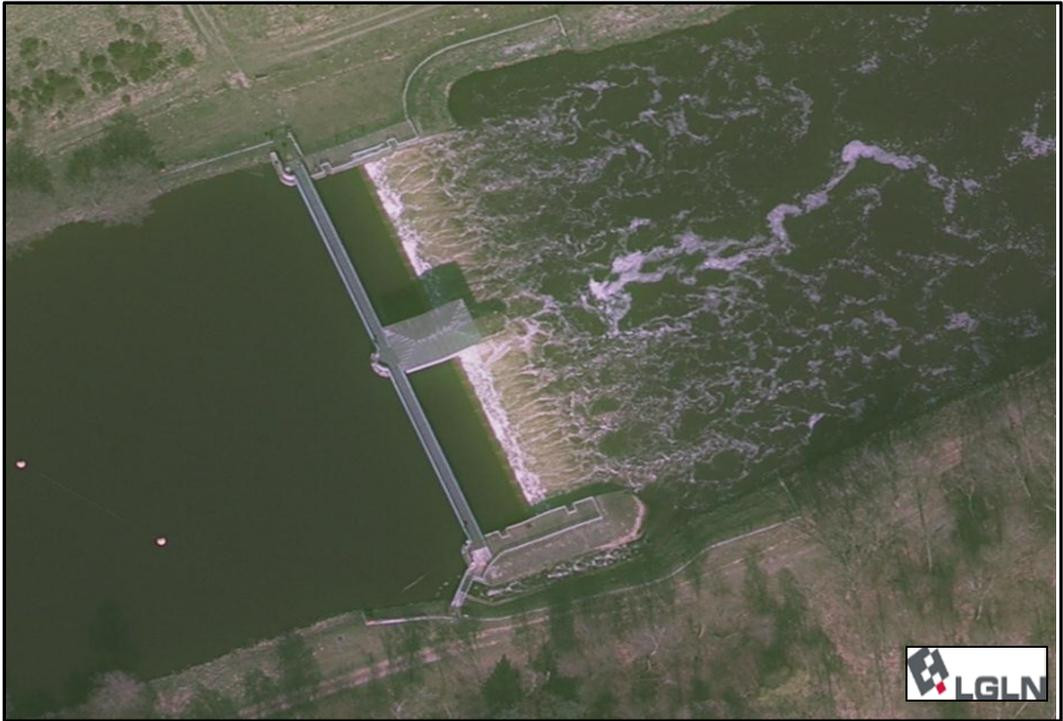
Abbildung 9: Aufsicht auf das Wehr Bollingerfähr und die Fischaufstiegsanlage (unten im Bild) (Quelle: Auszug aus den Geobasisdaten der Niedersächsischen Vermessungs- und Katasterverwaltung, © 2015
