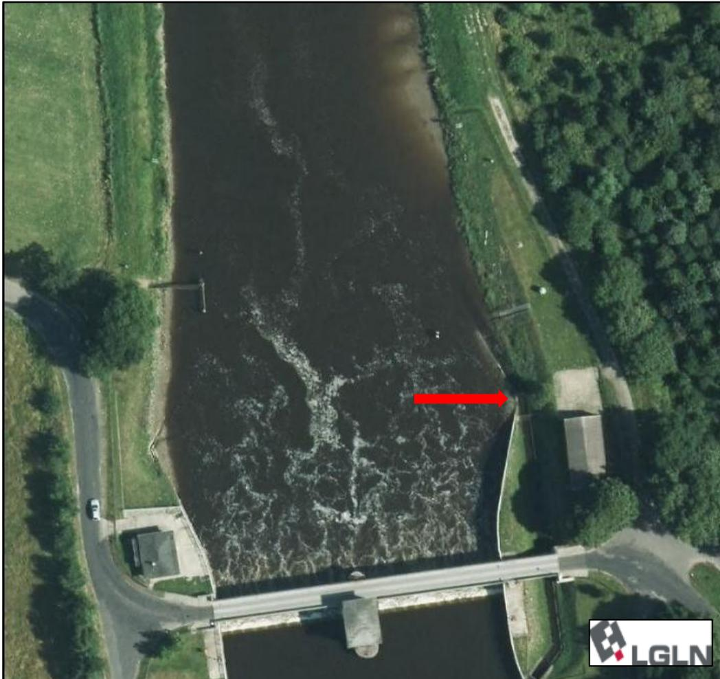
Abbildung 4: Aufsicht auf das Tidewehr Herbrum und die Fischaufstiegsanlage (FAA) an der rechten Uferseite. Der Pfeil markiert den Bereich, bis zu dem die FAA vom Unterwasser her ansteigt (vgl. Abbildung 6) (Quelle: Auszug aus den Geobasisdaten der Niedersächsischen Vermessungs- und Katasterverwaltung, © 2015).
