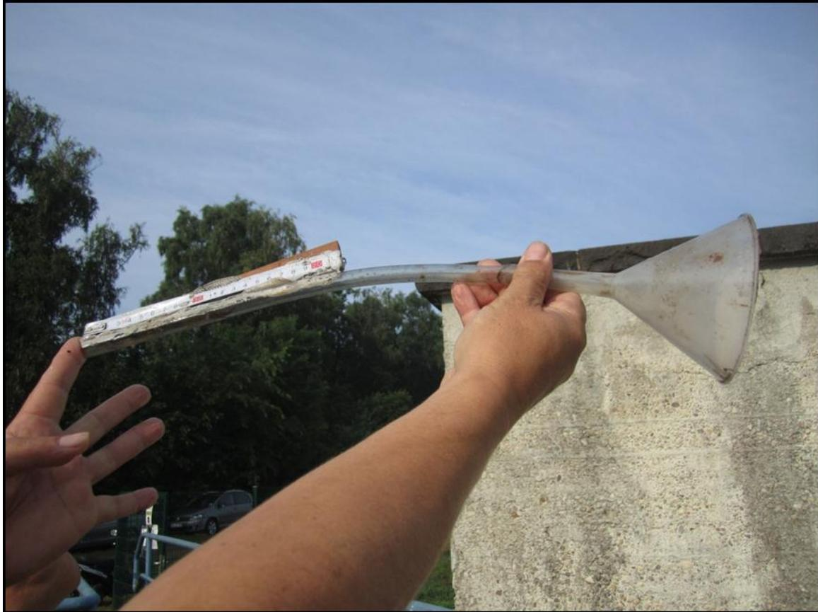
Abbildung 16: Längenmessung an einem Steigaal. Die Messung erfolgte mittels eines dafür konstruierten Messrohres (Quelle: Landesfischereiverband Weser-Ems).
