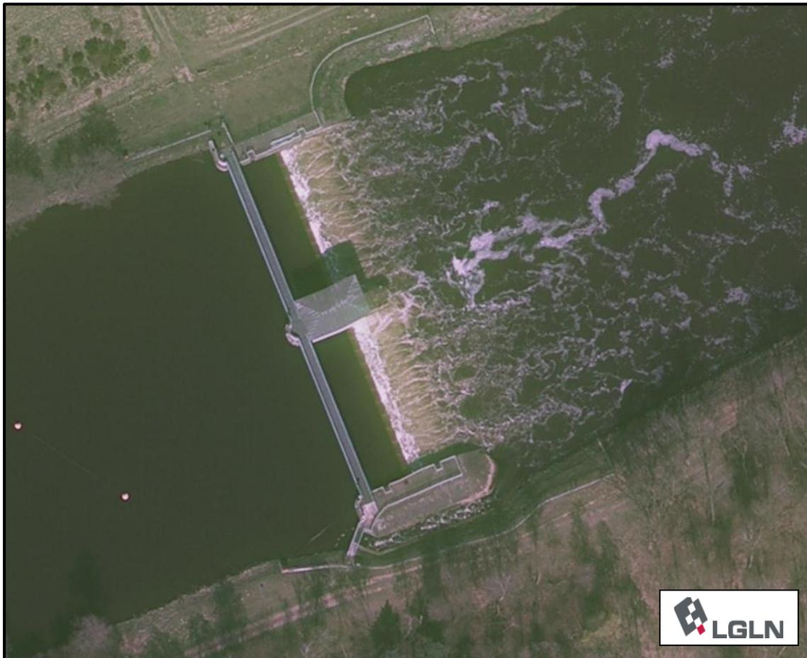
Abbildung 12: Aufsicht auf das Wehr Bollingerfähr und die Fischeaufstiegsanlage (unten im Bild)
