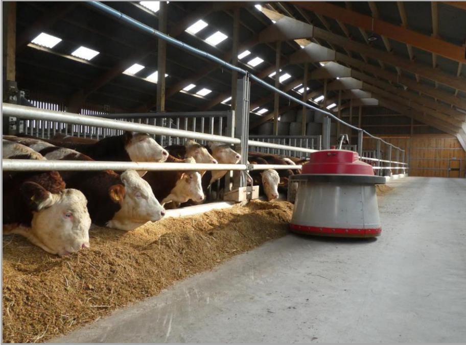
Der Anchieberoboter sorgt dafür, dass stets Futter angeschoben wird.
