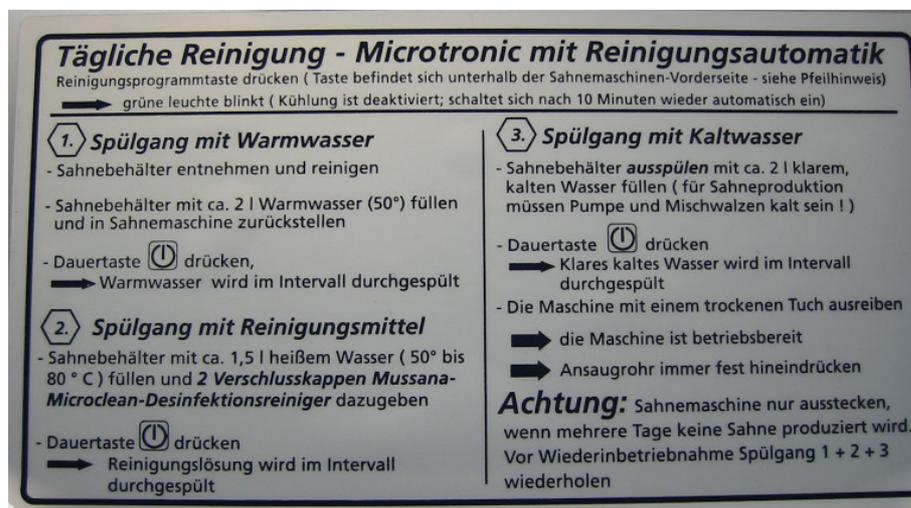
**Tägliche Reinigung - Microtronic mit Reinigungsautomatik**
