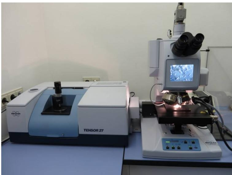
FT-IR Mikroskop zur Analyse der Mikropartikel
